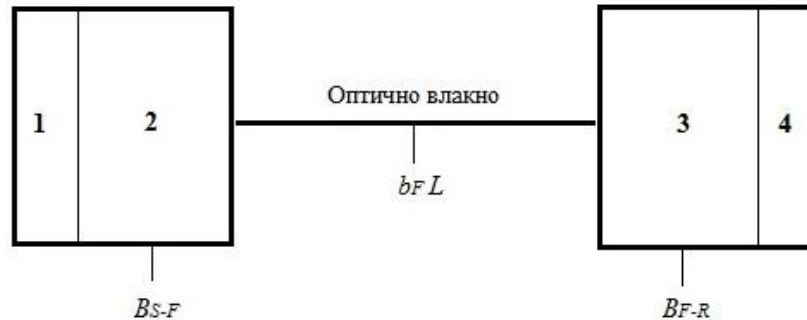
Фиг.1. Източник – 1 с мощност P_{in} [dBm] , оптично преходно устройство и разглобяемо съединение - 2 внасящи загуби B_{S-F} [dB] , разглобяемо съединение, оптично преходно устройство - 3 внасящи загуби B_{F-R} [dB] , фотоприемник - 4 регистриращ мощността P_{out} [dBm] на преминалото през СЛ лъчение.
