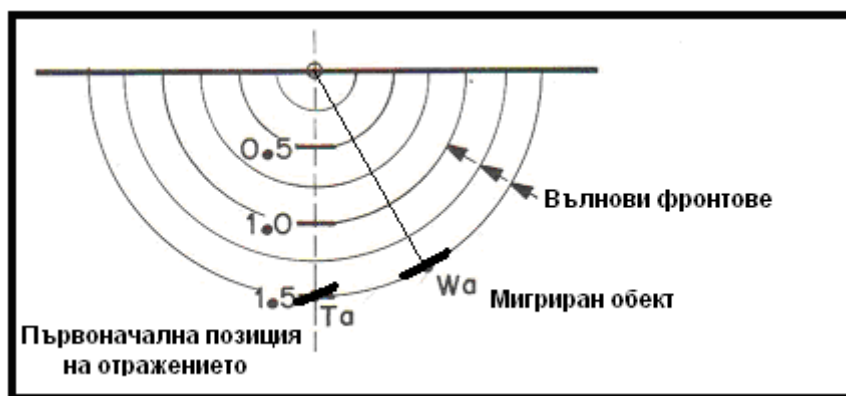
Фиг. 7. Принцип на действие на миграция [1]
